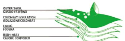
Il PD è un tessuto certificato conforme alle normative EN 471 + EN 343, impermeabile e traspirante, trattato esternamente Teflon, idrorepellente e oleorepellente, lascia scivolare via lo sporco e i liquidi velocemente. Resistente all'usura e anti-peeling, ha un'alta solidità del colore alla luce.
